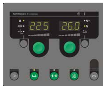
Advanced synergický řídicí panel s funkcemi PowerArc™ a DUO Plus™. Funkce DUO Plus™ umožňuje vytváření svarů s obdobným vzhledem jako při použití metody TIG a dosažení lepší kontroly nad vytvářením taveniny. Obsahuje programy pro MIG pájení a MIG/MAG svařování nízkouhlikových ocelí, nerezavějících ocelí a hliníku plnými nebo trubičkovými dráty. Umožňuje i manuální MMA a MIG/MAG svařování.
