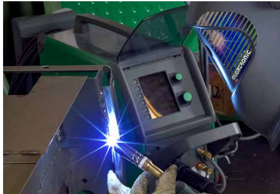
Ve svařovacím stroji Sigma Galaxy je výkonný počítač, který upravuje parametry procesu až 50 000krát za sekundu.
