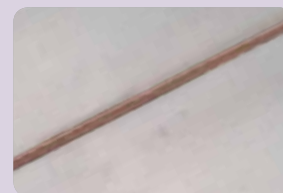
Spájkovanie pozinkovaných plechov pri výrobe vozidiel
