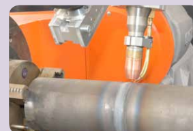
Zváranie rúra-rúra alebo rúra-príruba
