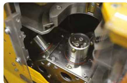
ATChanger: Zásobník pre 8 plazm. hláv ATChanger: magazine for 8 torch heads
