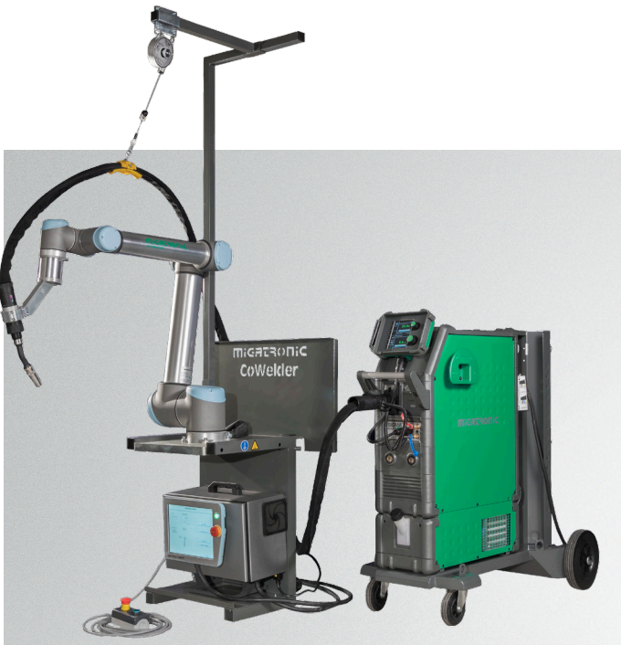
CoWelder s vodou chlazeným svařovacím strojem Sigma Select 400 s grafickým ovládacím panelem a robotickým ramenem UR5.
