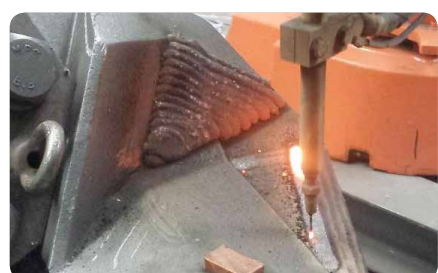
Povlakovanie miešačov hliny plneným drôtom robotom
