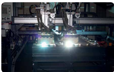
Portál s koľajnicovým zariadením pre povlakovanie nosných plechov
