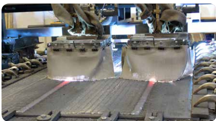
Nanášanie oteruvzdornej vrstvy na plechy podľa požiadaviek
