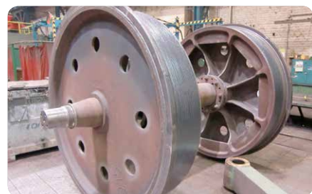
Obnova kolies korčiekových bagrov
