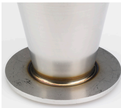
Kuželová trubka s přírubou – tlaková plazma, spoj plechů různých tloušťek.
