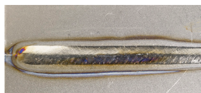
Nerezová ocel – průvarová plazma na tloušťce 6 mm
